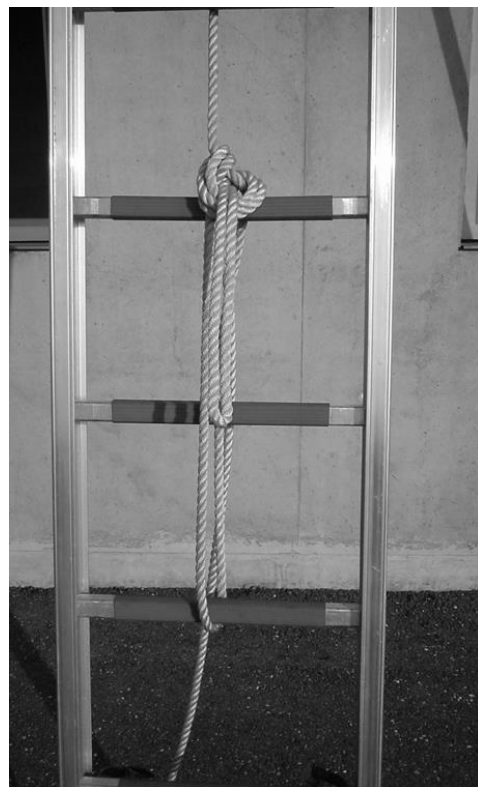
Sicherungsknoten bei der Schiebleiter: Mindestens drei Sprossen umschlingen, Mastwurf gestochen über der Sprosse ODER Mastwurf gestochen unter der Sprosse ODER Mastwurf gestochen links und rechts neben Zugseil
